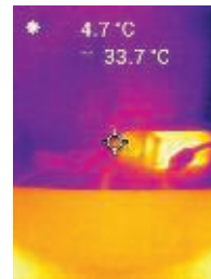
رسم ٥.٤ قراءة درجة حرارة المزوجة الحرارية (33,7°C، في هذا المثال)
