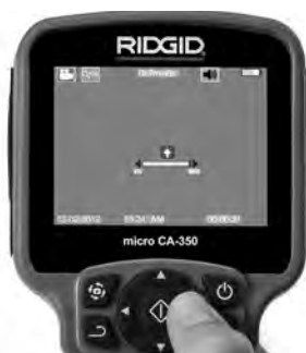
Figure 14 – Réglage des LED
