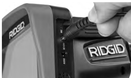
Figura 6 – Alimentación del aparato con el adaptador CA
