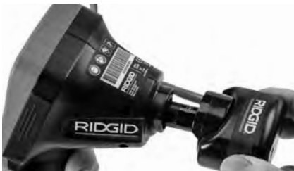
Figura 18 – Conexión entre la micro CA-350 y un equipo de inspección SeeSnake
