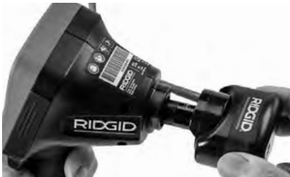
Figure 18 – Connexion du câble de tête de caméra
