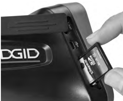
Figura 9 – Introducción de la tarjeta SD
