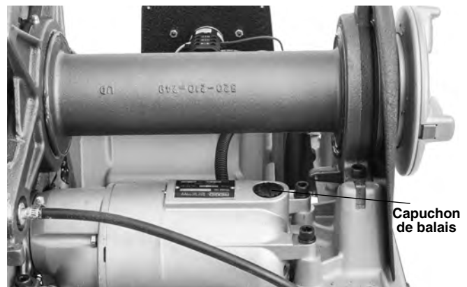
Figure 34 – Retrait du capot et remplacement des balais
